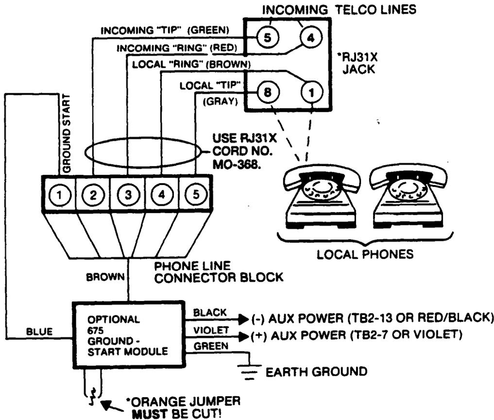
**Diagram 28. PHONE LINE AND GROUND START CONNECTIONS**
