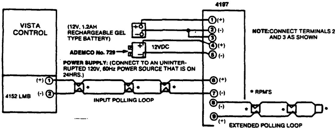
4197 POWERED FROM LOCAL POWER SUPPLY AND BATTERY
